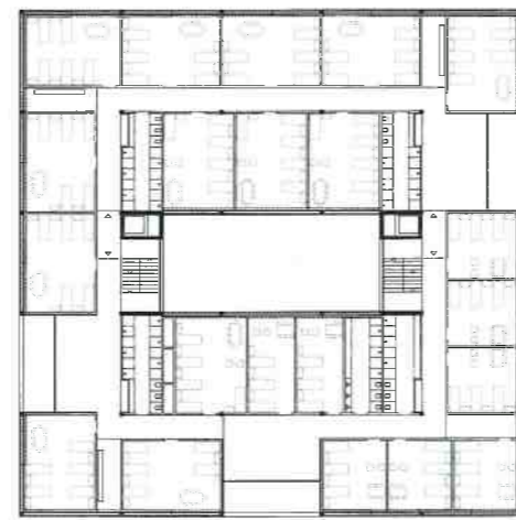
2. Rang, 2. Preis «Camaleonte»: Die modulare Bauweise gibt die Funktion des Gebäudes nicht zu erkennen. Die durchbrochenen Betonfassadenelemente grenzen das Gebäude stark vom Aussenraum ab. Grundriss 1. OG, Mst. 1:700.
